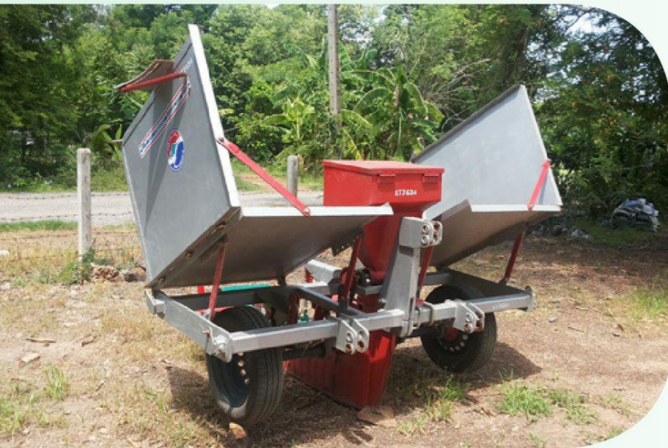
>> "เครื่องปลูกอ้อยแบบใช้ต้นกล้า" ที่เรียกว่า "SHUTE PLANTER"
